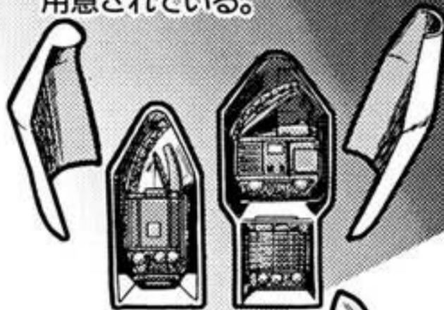
第2段エンジンLE-5B。LE-5Aの改良型で、タンク構造も製造しやすいものに変更。
