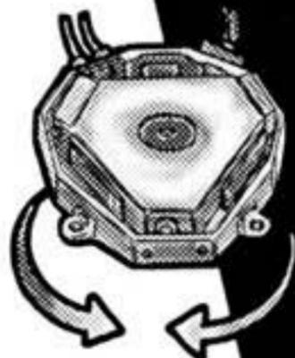
ロケットが自分の姿勢を知るためのリングレーザージャイロ。機械式ジャイロに比べ高精度を誇る。
