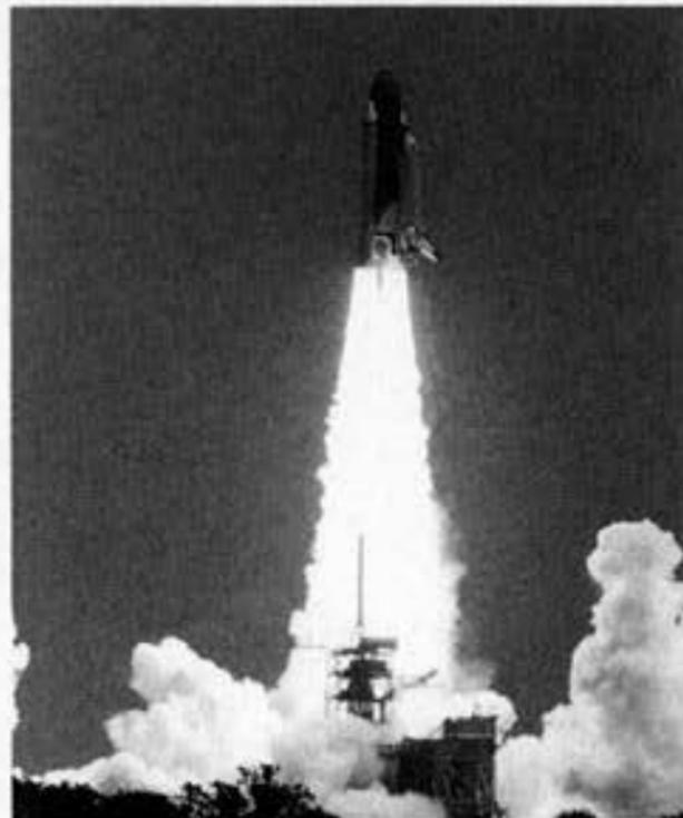
しかしそこまでだった。1986年1月28日の早朝、スペースシャトル「チャレンジャー」が打ち上げ後73秒で爆発、七名の宇宙飛行士が死亡した。固体ロケットブースターの継ぎ目に装着されたガス漏れ防止用のリングというパッキングが、早朝の低い気温で弾力を失ってしまい、高温の燃焼ガスが漏れてブースターと外部タンクをつなぐ金具を溶かしてしまったのだった。
