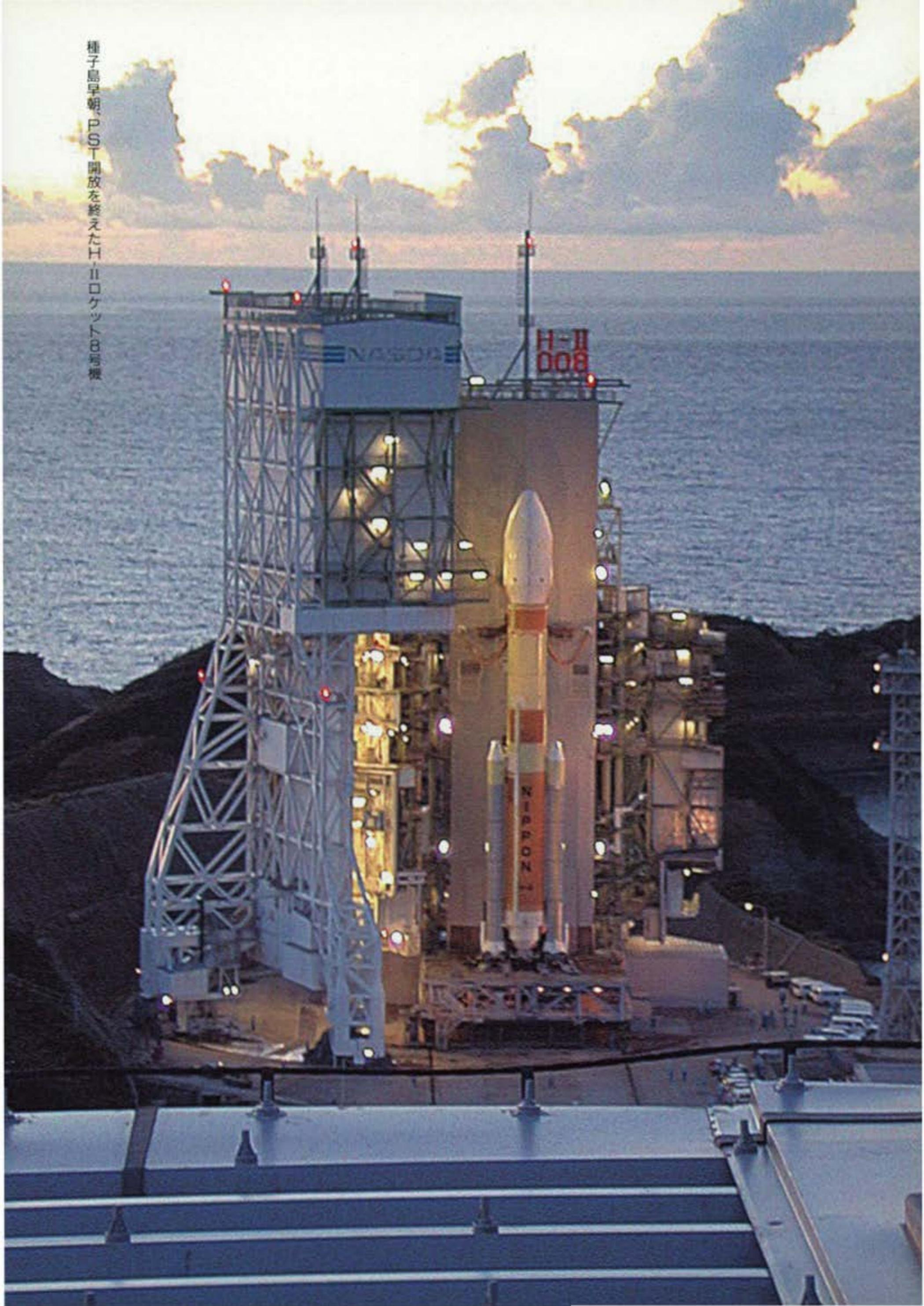
→打ち上げ数分前の8号機。既に液体燃料は満タン、自動カウントダウンが開始されている
